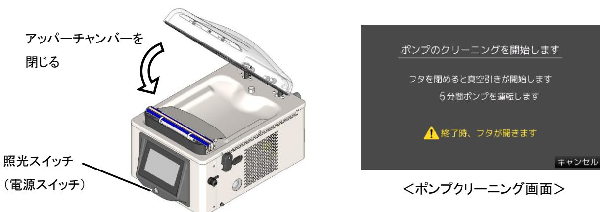
作業終了後ポンプクリーニングを行うことで、ポンプオイル内の水分を取り除き、水分混入による劣化を防ぐことができます。
