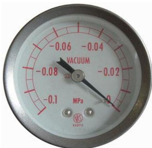
操作パネル左側に真空計が設置してあります。目盛りは0～-0.1MPaまで表示されており、-0.1MPa側に指針が動きだすと、チャンバー内部の気圧が大気圧に対して、減ってきていることを示しています。
