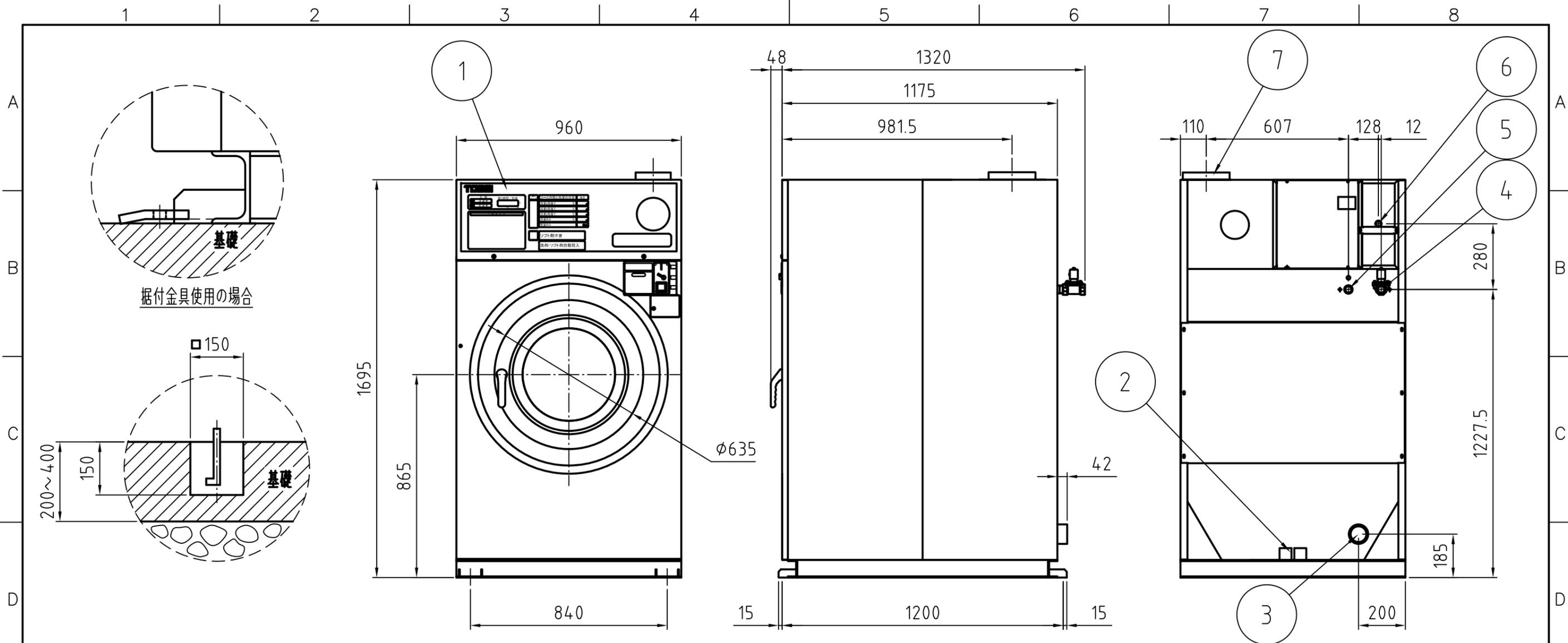
注1) 機械の水平を出してから、据え付ける事。
