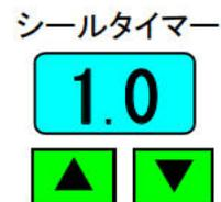
※ 包装袋の厚さによりシール時間が異なりますので、下記の時間を目安に最適のシール時間に調整してください。
