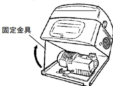
**2** ポンプのカバープレートの六角ボルト4本を外し、カバープレートを取り外します。
