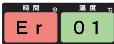
・エラーが発生すると、停止中のランプが点滅し、時間・温度表示にエラー番号が表示されます。
