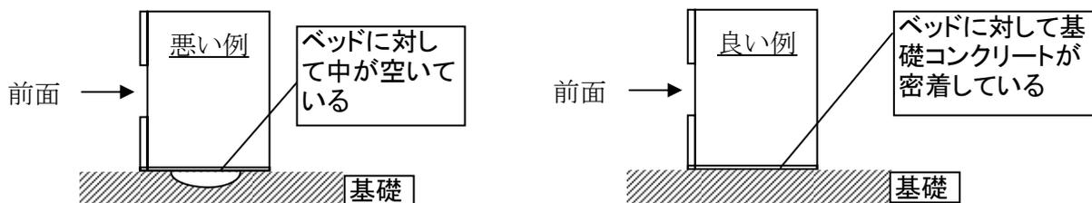
\* 基礎コンクリートに対して、中空部(排水口、溝など)によってベッドが完全に密着していない場合、振動の原因になるケースがあります。
