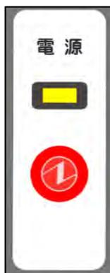
・操作回路へ電気を供給するスイッチで、スイッチONで電源ランプが点灯します。
