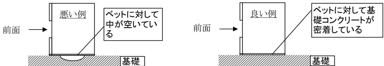
\* 基礎コンクリート対して、排水口等によってベットが完全に密着していないため、振動の原因になるケースがあります。
