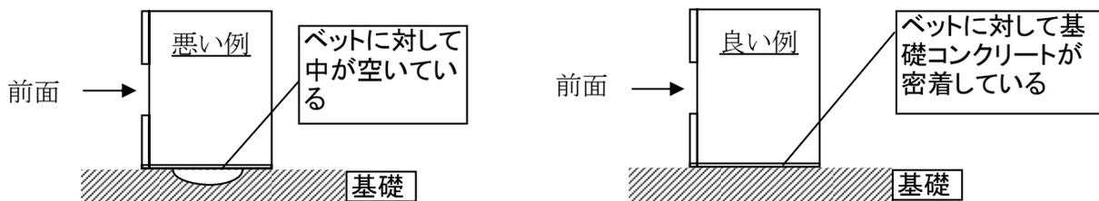
\* 基礎コンクリートに対して、排水口等によってベットが完全に密着していない為、振動の原因になるケースがあります。
