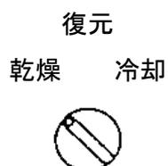
・設定中に有効なスイッチで工程別の時間を変更する時に使用するスイッチです。
