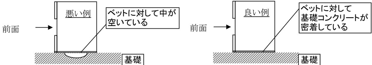
\* 基礎コンクリートに対して、中空部(排水口、溝)によってベッドが完全に密着していない為、振動の原因になる場合があります。
