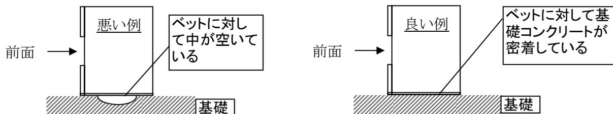
\* 基礎コンクリートに対して、排水口によってベッドが完全に密着していない為、振動の原因になるケースがあります。
