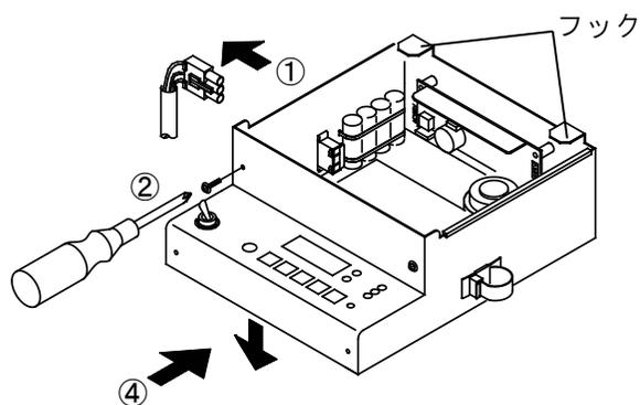
1. 電源スイッチを切り、電源プラグを抜いてから、電源入力のコネクタを外してください。
